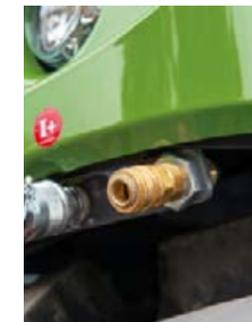
Trois raccords d'air comprimé intégrés permettent de souffler les composants importants de la machine directement dans le champ.
