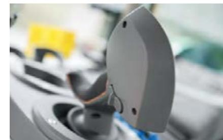
À l'arrière du joystick multifonction, le rouleau tasse andain du pick-up peut être actionné aisément. Lors de l'ensilage de maïs, cet interrupteur sera utilisé pour orienter manuellement le cueilleur et actionner les clignotants sur route.
