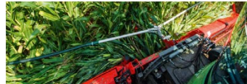
Le cueilleur à maïs existe en huit, dix ou douze rangs. Pour les déplacements sur route, la tête de récolte est repliée hydrauliquement en position de transport en un minimum de temps.
