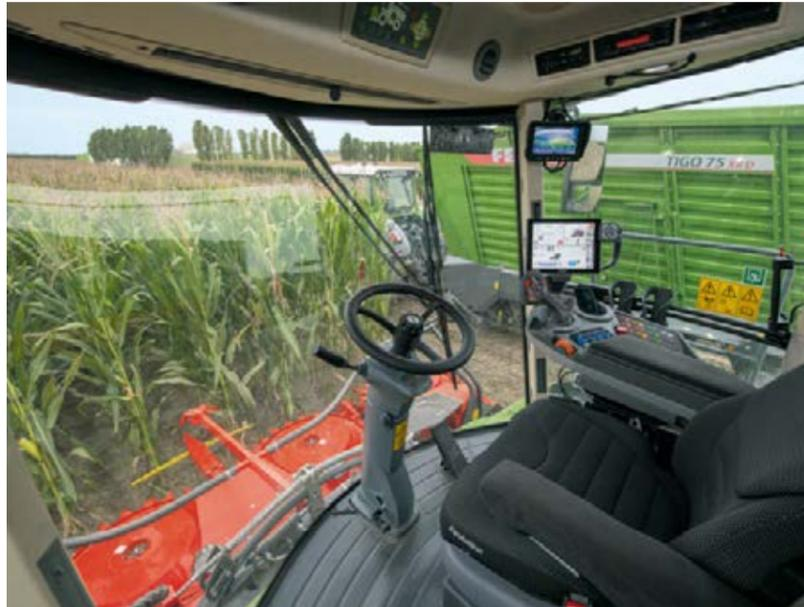
La cabine Visio5 est conçue pour optimiser la visibilité et offre une ergonomie et un fonctionnement parfaits sur l'environnement de travail. Grâce à la forme spéciale du contour du toit, la goulotte est toujours dans le champ de vision du conducteur. L'environnement de travail reste agréable grâce à la climatisation et au chauffage automatique.
