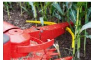
Grâce au palpeur de suivi de rang monté sur la tête de récolte de maïs, la Katana se déplace rapidement dans les cultures et de façon automatique, avec une précision de l'ordre du centimètre.
