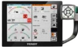
La charge du moteur et la vitesse d'avancement maximale avec le contrôle de charge maximale peuvent être paramétrés sur le terminal, afin d'ajuster le dispositif aux conditions actuelles.
