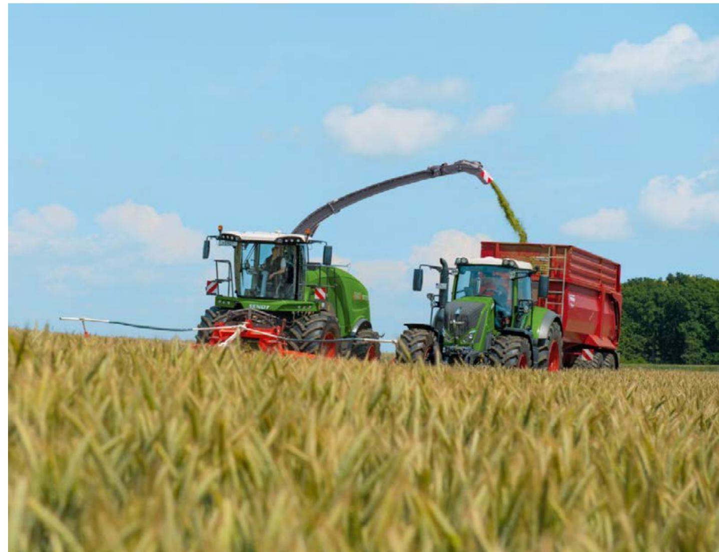
L'alliance des systèmes de guidage et du contrôle de charge maximale soulage le conducteur, garantit une utilisation optimale de l'ensileuse et permet au conducteur de travailler de façon plus détendue.
