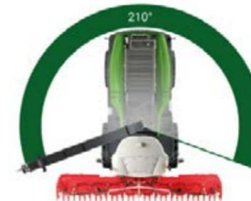
Même avec une hauteur de chargement de plus de six mètres, la goulotte reste dans le champ de vision du conducteur. Pour optimiser le remplissage de la remorque, celle-ci peut être rallongée lors de l'utilisation de larges têtes de récolte.
