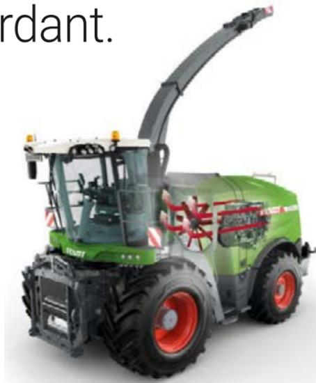
Le ventilateur à pas variable n'aspire pas plus d'air que nécessaire. Ce qui permet d'optimiser les performances moteur en fonction de la tâche réalisée et de la puissance requise, et augmente le rendement global de la Fendt Katana. La fonction d'inversion du ventilateur repousse la saleté du radiateur, à des intervalles réglables, en inversant le flux d'air. Par conséquent, le radiateur fonctionne toujours à sa capacité de refroidissement maximale et les périodes de nettoyage sont allongées.
